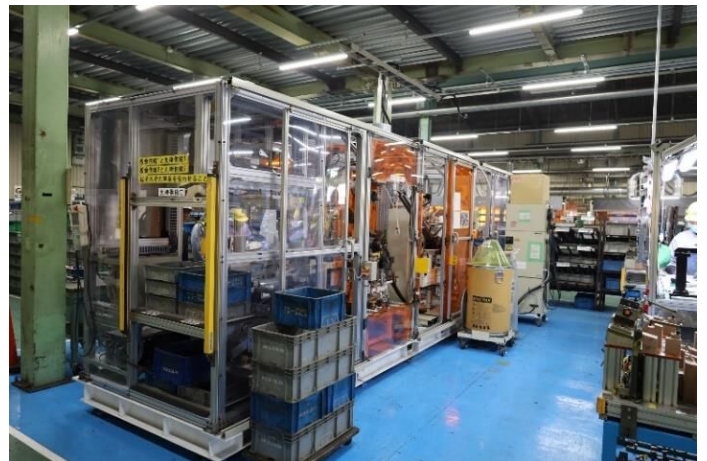
（ロボット 3 台と自動化セル 3 式のロボットシステム全体像）
